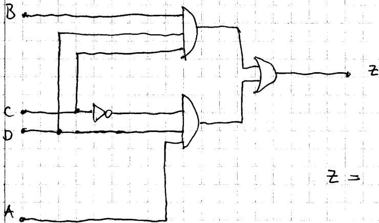
$$Z = \bar{B} \cdot \bar{C} \cdot \bar{D} + A \cdot \bar{C} \cdot D$$
