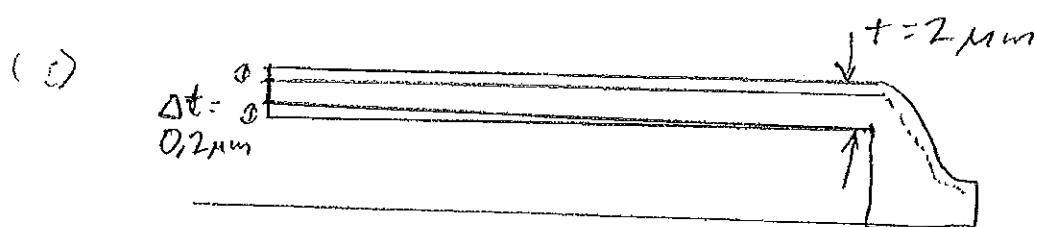
d)  $t_{\min} = 2 - 0,2 - 0,2 = 1,6 \mu\text{m}$
