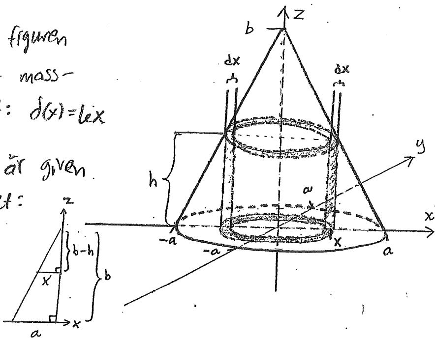
$$\text{Stålets volym: } dV = \underbrace{2\pi x}_{\text{omkrets}} \cdot \underbrace{h}_{\text{höjd}} \cdot \underbrace{dx}_{\text{tjocklek}} = 2\pi b x \left(1 - \frac{x}{a}\right) dx$$
